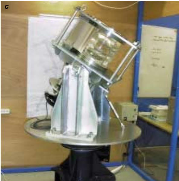
lution au sein du noyau terrestre serait l'un des éléments responsables, via la création de courants électriques, du champ magnétique de la Terre. Pour étudier l'effet des mouvements de l'axe de la Terre sur le noyau, de l'eau est mise en rotation (avec précession) dans un ellipsoïde en plexiglas (c).
