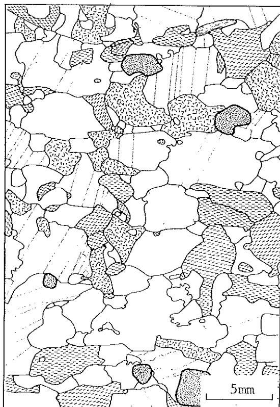
FIG. 4. — a : Structure tabulaire à gros grain. Dessin d'après lame mince de l'échantillon M 57 (Monastrey). La trace de la foliation est horizontale et la direction préférentielle des clivages (100) de l'enstatite définie sur échantillon est E-W. Mêmes figurés que pour la figure 3 a ; grenat : contours épais, pointillés serrés ; phlogopite : traits fins.
