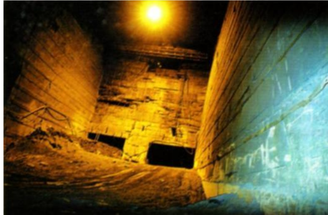
Chambre d'exploitation dans une ardoisière d'Anjou, exploitée par la méthode descendante. ( extrait de Evaluation des aléas liés aux cavités souterraines, INERIS, LCPC )
