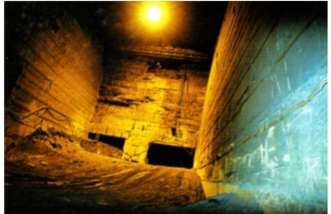
Chambre d'exploitation dans une ardoisière d'Anjou, exploitée par la méthode descendante. ( extrait de Evaluation des aléas liés aux cavités souterraines, INERIS, LCPC )
