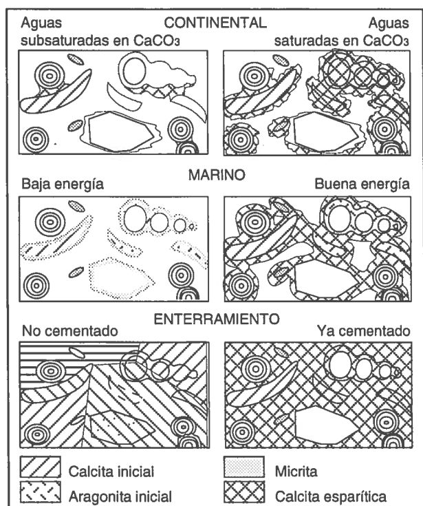
Fig. 23 : Tipos de cementación, según las condiciones de diagénesis precoz, según Tucker y Wright (1990).
