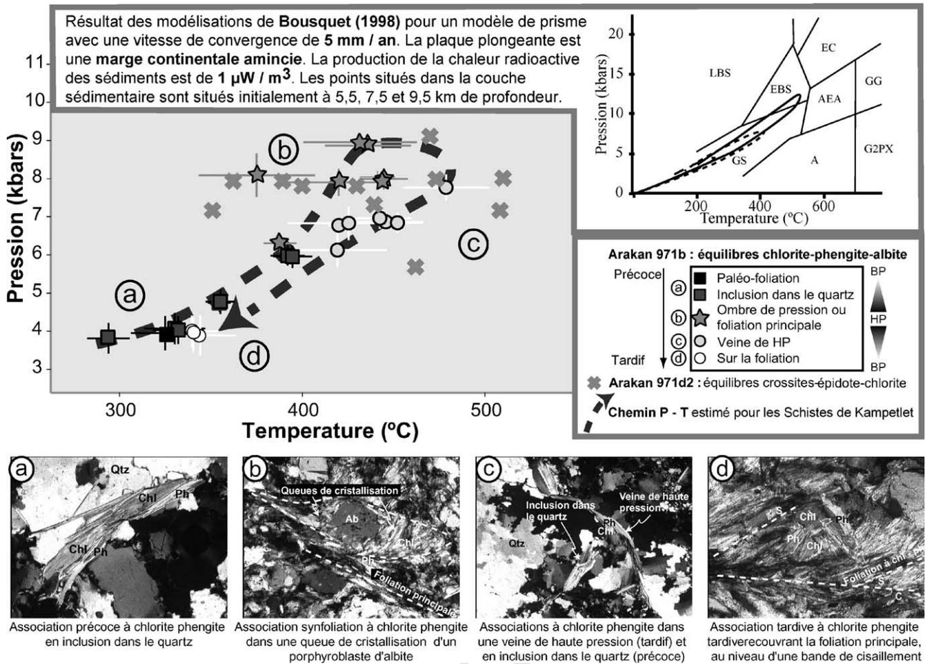
**Figure 4.** Trajet  $P$ - $T$  des schistes de Kampetlet, estimé grâce aux calculs multi-équilibres sur les associations chlorite–mica et crossite–chlorite. Relations microtexturales entre les différentes associations chlorite–mica. Comparaison avec les modélisations thermiques de Bousquet.
