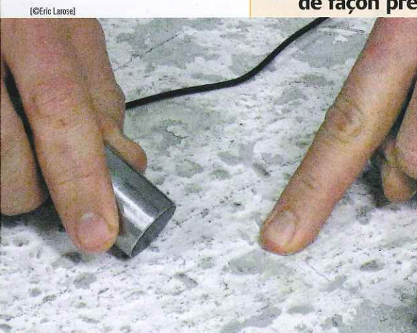
Exemple de transducteur ultrasonore positionné sur le béton, juste avant son collage.
