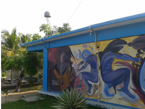
Deux stations GPS permanentes, l'une sur le toit de l'école de Papanoa, lieu de l'épicentre du séisme d'avril 2014 (station PAPA, photo de gauche) et l'autre au cœur de la lacune sismique de Guerrero, surplombant la baie d'Acapulco (ACAP, à droite).
