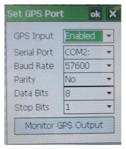
Monitor GPS Output permet de s'assurer du bon fonctionnement du GPS (visualisation des trames NMEA, qui sont les données transmises par l'antenne GPS)
