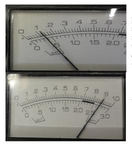
La mesure de l'état de la batterie de l'EM3& peut se faire directement sur l'appareil. Tournez le sélecteur MODE sur OPER et le sélecteur milimhos/meter sur + puis sur -. L'aiguille doit se trouver sur une valeur sur l'échelle B comprise entre 0 et 0,5 en mode + , 2,5 et 3 en mode - . Si vous avez une valeur différente, rechargez les piles.
