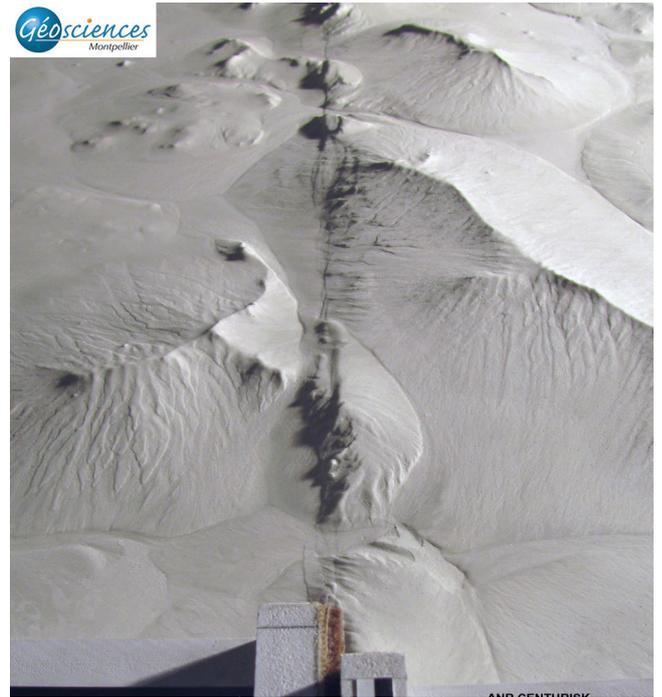
**Figure 9 : Nouveau protocole analogique**, permettant le suivi quantitatif de la morphologie et des marqueurs alluviaux qu'elle comporte, en fonction des glissements sismiques répétés sur la faille, de l'érosion et de la sédimentation
