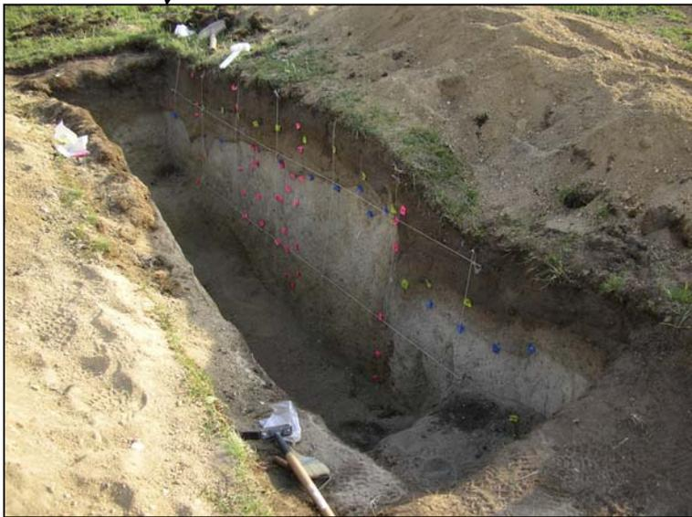
Analyse des ruptures et datation d'horizons sismo-sédimentaires dans des tranchées paléosismologiques:
