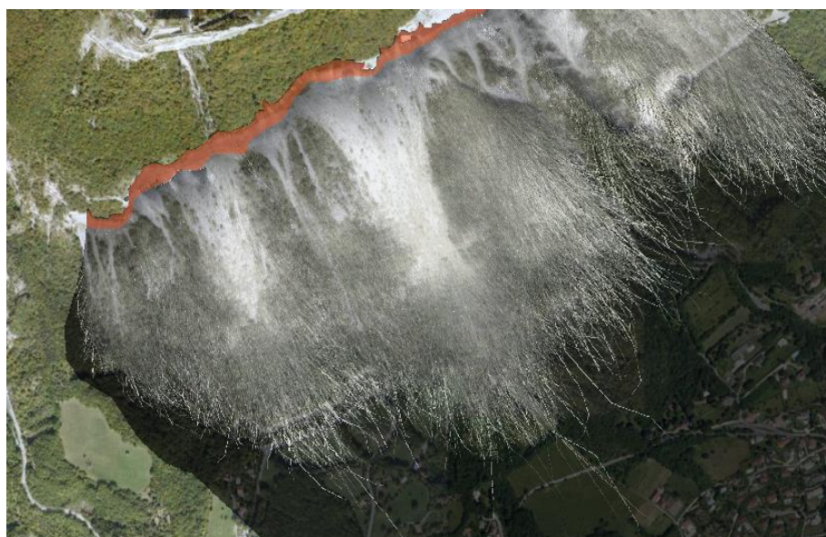
Figure 5. Trajectoires des blocs de plus de 1 \text{ m}^3 tombant de la falaise pendant une période de 1000 ans (simulation Rockyfor3D).
