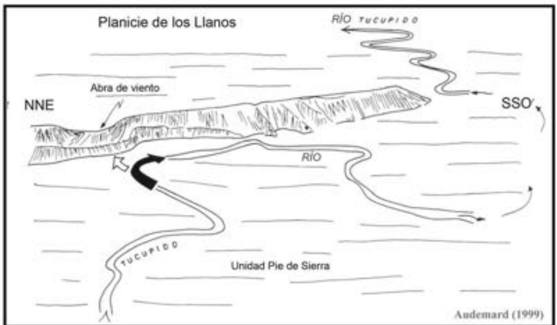
FIG. 5.5.4.10. Vista oblicua de la desviación del río Tucupido por detrás de la Flexura frontal surandina (foto y esquema explicativo). Nótese el abra de viento dejada por el río al no poder seguir venciendo el crecimiento vertical del escarpe.
