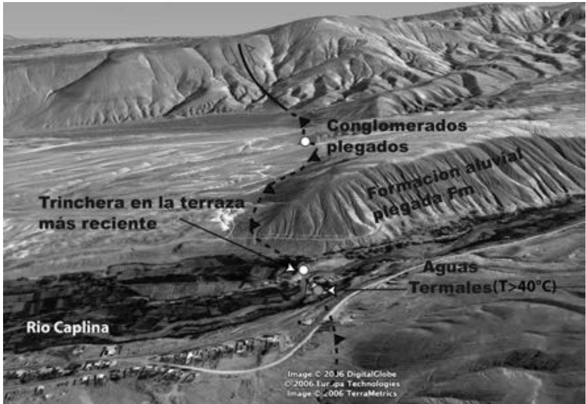
FIG. 5.1.9.5. Imagen de Google Earth, donde se muestra un segmento de la falla inversa Sama-Calientes. Se señala en la misma ubicación la fuente de aguas calientes y afloramiento que expone falla inversa en terraza reciente (punto en blanco).
