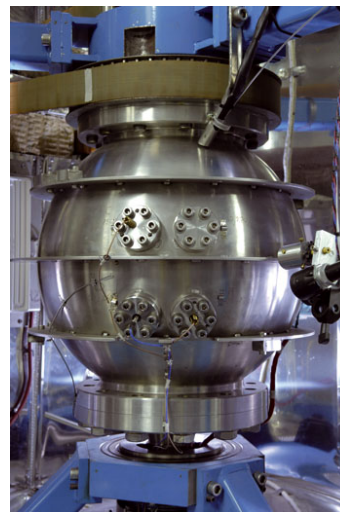
Figure 1.1: Photo de la sphère externe de l'expérience DTS. On aperçoit quatre cylindres boulonnés à la surface, il s'agit de l'emplacement des sondes Doppler.
