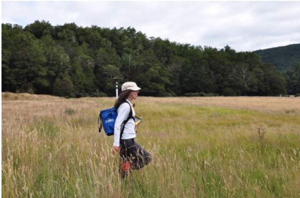
Figure 1-08 : doctorante qui réalise un MNT avec une antenne GNSS fixée sur le sac à dos et en arpentant l'ensemble du terrain à couvrir (photo : A. Schlagenhauf, Nouvelle-Zélande, 2010).
