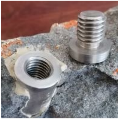
Figure 1-05 : à gauche, photo de repère à centrage forcé ; à droite, photo d'installation de station GNSS sur un centrage forcé (site DANC, Pérou, 2011).
