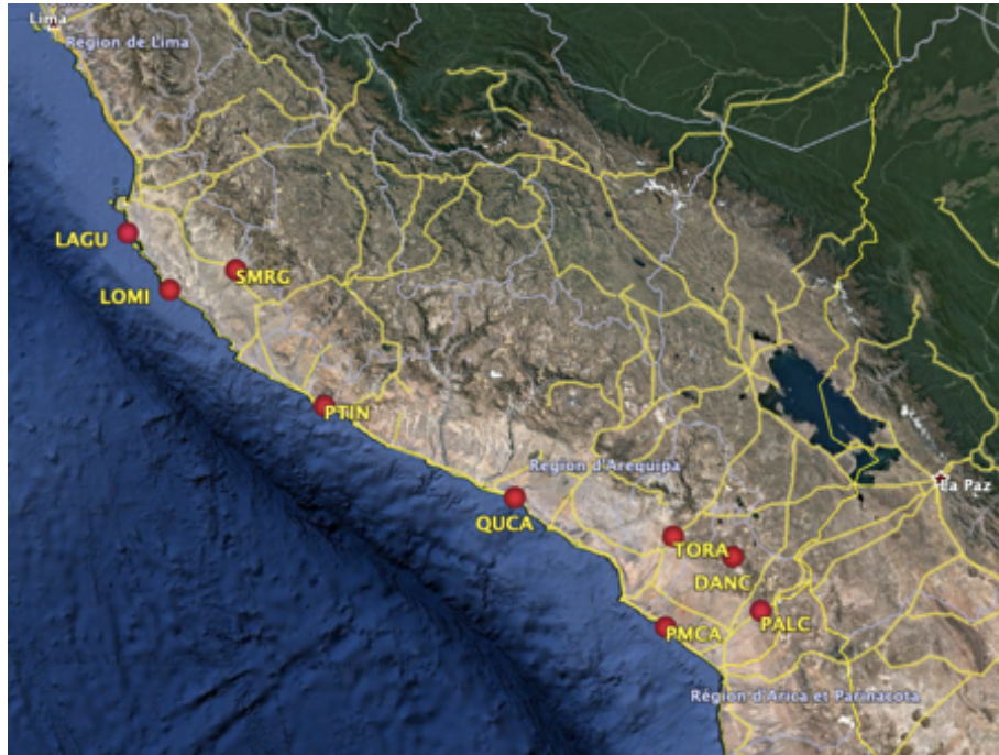
Figure 1-15 : carte des 9 stations GNSS permanente installée en 2011 au Sud Pérou (@Google Earth), depuis la lagune de Paracas jusqu'à la frontière chilienne.
