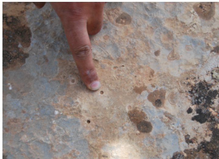
Figure 1-06 : un repère impossible à voler mais parfois difficile à retrouver : le trou ! (site AASS, Liban, 2010).
