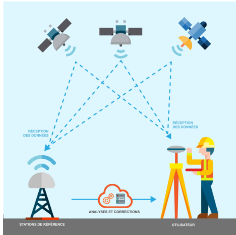
Figure 1-03 : fonctionnement de la méthode de relevé local en temps-réel (source : site web du réseau TERIA).
