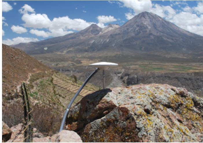
Figure 1-05 : à gauche, photo de repère à centrage forcé ; à droite, photo d'installation de station GNSS sur un centrage forcé (site DANC, Pérou, 2011).
