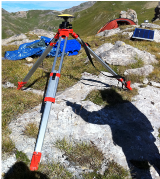
Figure 1-04 : installation d'un trépied sur un repère scellé dans le rocher et indiqué par l'ombre du doigt (site CGA0, col du Galibier, juillet 2011).
