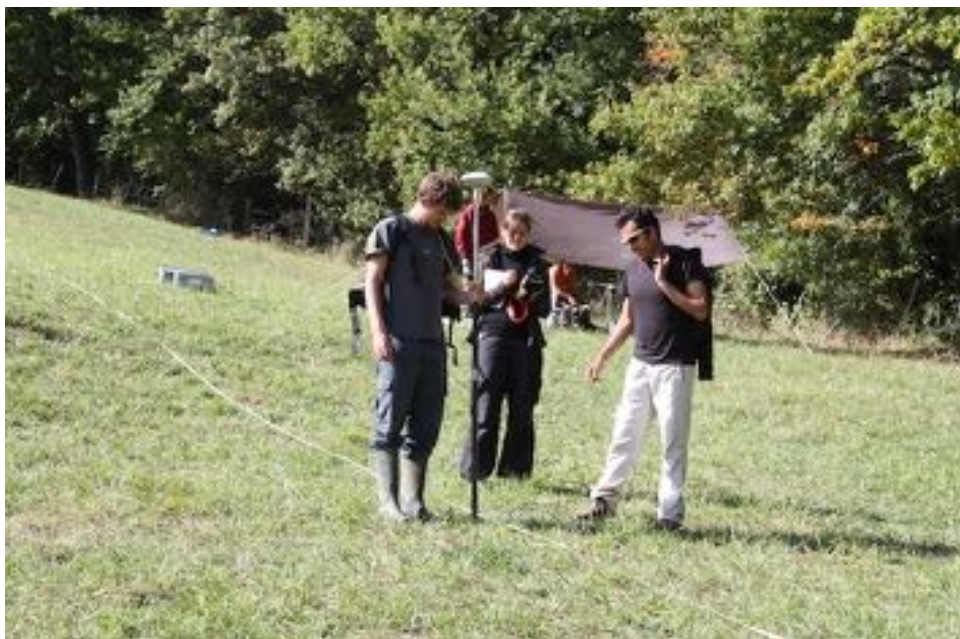
Figure 1-07 : des étudiants en train de relever les positions d'électrodes (profil électrique) avec une station GNSS montée sur une perche. La station utilisée est donc « mobile » et permet un positionnement en temps-réel grâce aux signaux envoyés par une station installée en fixe et qui envoie ses corrections (Avignonet, 2010).
