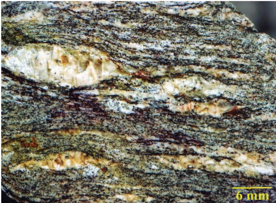
**Gneiss du Velay.** Orthogneiss provenant du métamorphisme de granites monzonitiques porphyroïdes (528 Ma, Cambrien supérieur). Ils constituent le toit du granite du Velay. Ce sont des gneiss oeilés, **foliés** à porphyroclastes de feldspath potassique, quartz, biotite, plagioclases, feldspath potassique, sillimanite. Les porphyroclastes sont des phénocristaux magmatiques hérités du granite. De la muscovite tardive apparaît sur les feldspaths potassiques.
