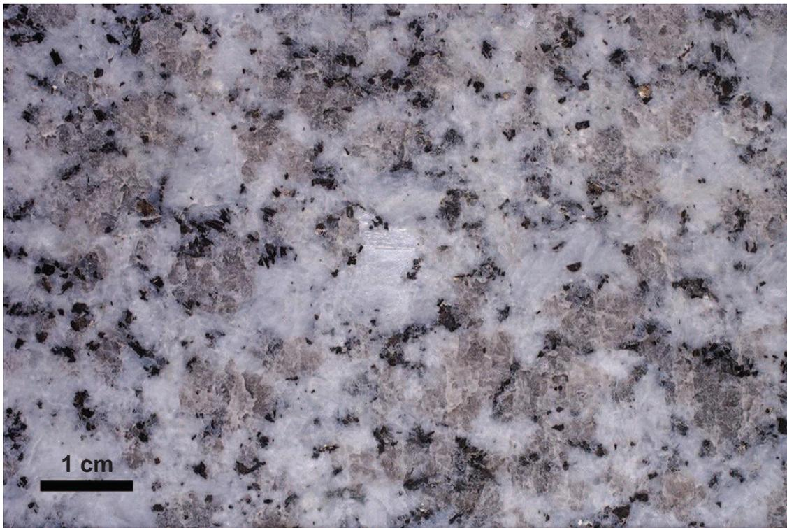
Granite gris du Sidobre (poli). Blancs : **feldspaths** (microcline 12% et plagioclases 39%) ; gris : **quartz** 39% ; noir : **biotite** 10%. Bon exemple de structure holocristalline (= *entièrement cristalline*). Ce granite est en réalité une granodiorite intrusive.
