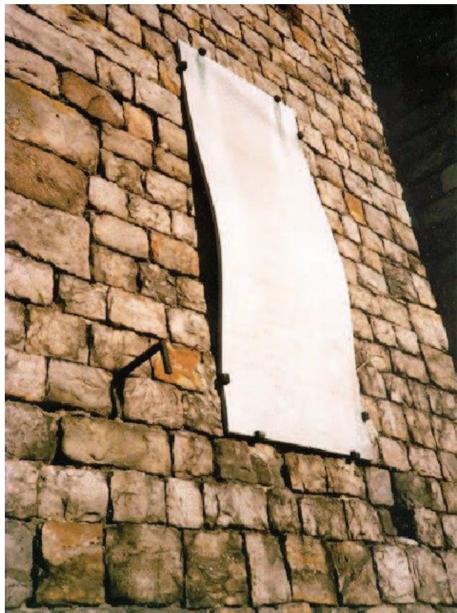
Fluage d'une plaque de calcaire lithographique (photo André Lardon)
