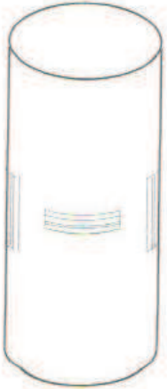
Figure 3-14 : Position des jauges
