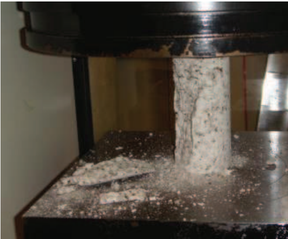
Compression uniaxiale sur un granite
