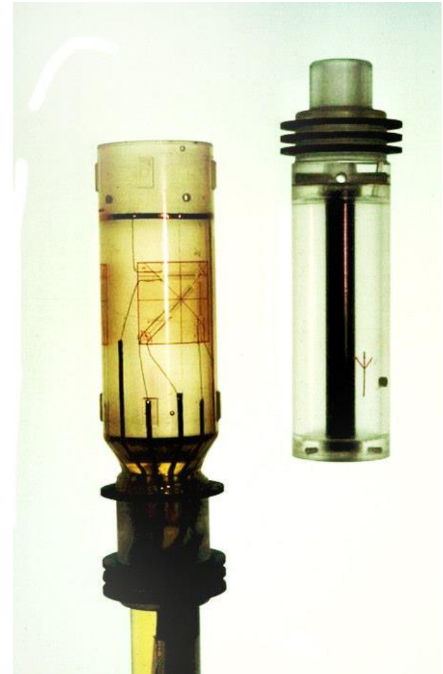
Cellule de déformation pour la mesure des contraintes par surcarottage, développée en Australie (Worotnicki and Walton 1976)
