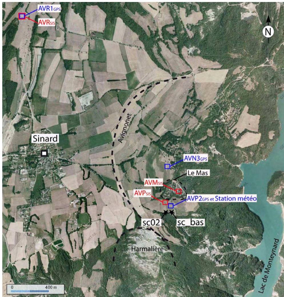
FIG. 2 – Présentation du site d'étude et localisation des instruments utilisés. Les stations GPS (AVN3, AVP2 et AVR1). Les stations sismologiques 3 composantes (AVR, AVP et AVM) , la station météorologique et les deux forages équipés de capteurs CPI. Les limites des combes d'Avignonet et de l'Harmalière sont représentées en pointillés (image Géoportail©)
