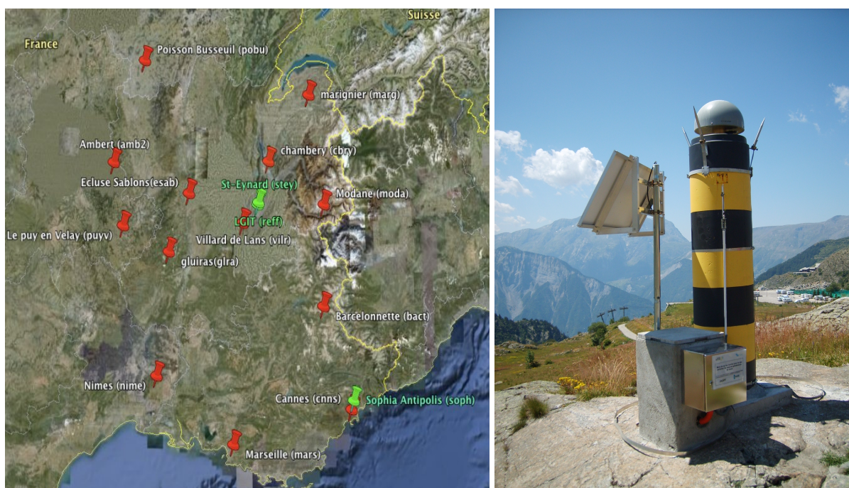
(a) Réseau des stations utilisées dans l'analyse des données GPS haute fréquence. (b) Station permanente à l'Alpe d'Huez, Isère.
