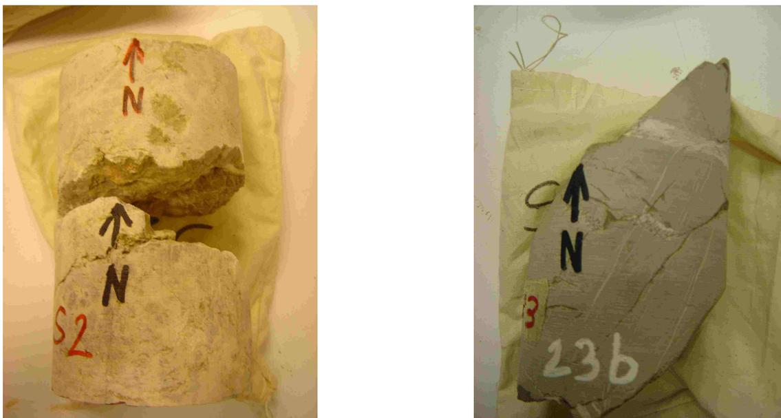
FIG. 3.3 – Carottes utilisées pour les mesures de conductivité thermique.
