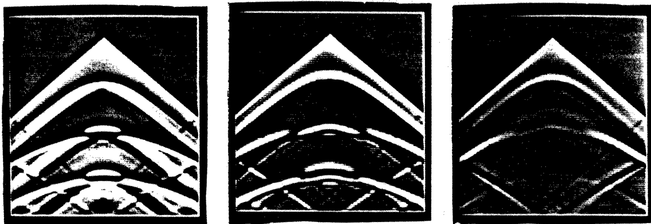
Figure 3.3.l : Profils sismiques pour une source au-dessus d'un dôme avec un offset de 4 km.
