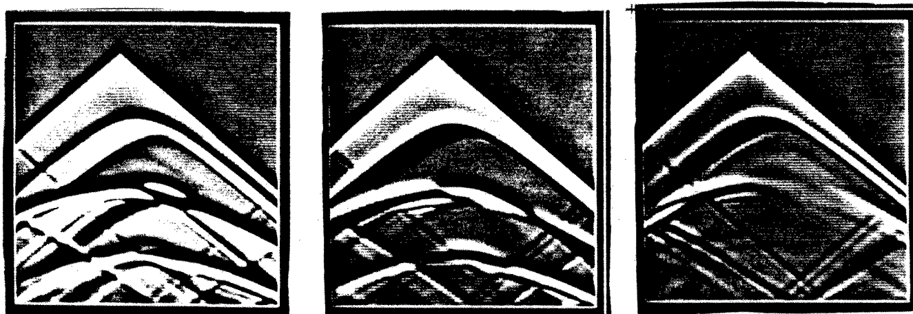
Figure 3.3.m : Profils sismiques pour une source au-dessus d'un dôme avec un offset de 3.2 km.
