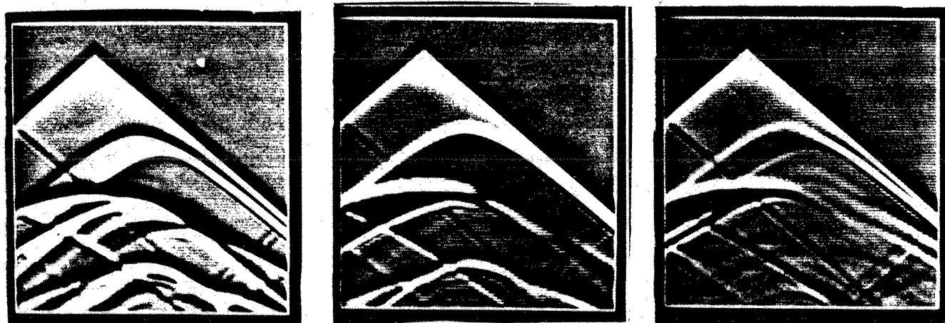
Figure 3.3.n : Profils sismiques pour une source au-dessus d'un dôme avec un offset de 2.4 km.
